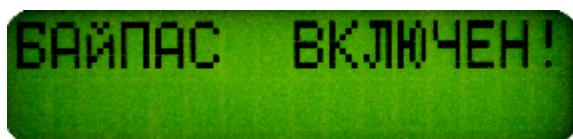
**Внимание!** Включить/выключить режим “Байпас” (Транзит) можно только при выключенном стабилизаторе. Если попытаться сделать это при работающем приборе (в режиме “Стабилизация” или в режиме “Байпас” (“Транзит”)) — входной автомат будет отключаться, чтобы избежать случайного включения/выключения режима “Байпас”.
