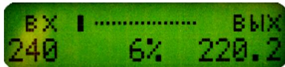
Высвечивается после тройного нажатия на кнопку «Вправо». Графический индикатор процента загрузки - показывает долю от максимально возможной при данном входном напряжении выходной мощности.
