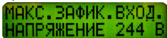
Максимально зафиксированное входное напряжение от последнего включения прибора. При выключении стабилизатора - сбрасывается.
