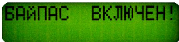
**Увага!** Включити / виключити режим "Байпас" (Транзит) можна тільки при вимкненому стабілізаторі. Якщо спробувати зробити це при працюючому стабілізаторі (в режимі "Стабілізація" або в режимі "Байпас" ( "Транзит")) - вхідний автомат відключиться, щоб уникнути випадкового включення / вимикання режиму "Байпас".
