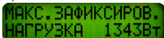
Максимальная зафиксированная нагрузка от последнего включения прибора. При выключении стабилизатора - сбрасывается.
