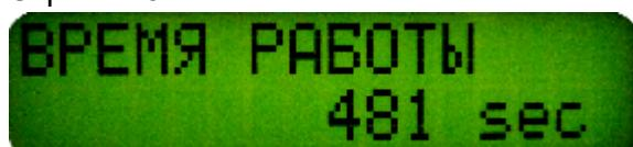
Время работы прибора с момента последнего включения. При выключении стабилизатора - сбрасывается.
