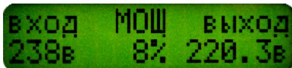
Высвечивается после одноразового нажатия на кнопку «Вправо»
